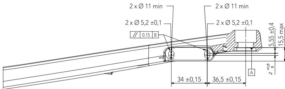
BRAKE CALIPER FIXING BOLT
