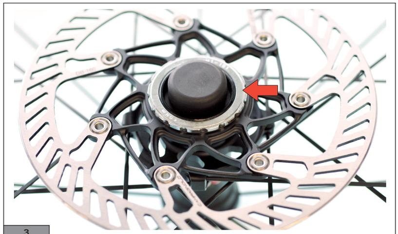
3) Tighten the locknut (Fig. 4).
