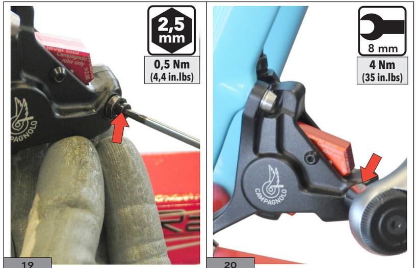
**18)** Torque tighten the bleed valve (Fig. 20).
